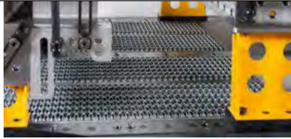
Montagehoogtes kunnen aan het werkstuk worden aangepast door eenvoudigweg de poten te wisselen.
