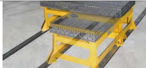
Opbouw in lengte- en dwarsrichting.
