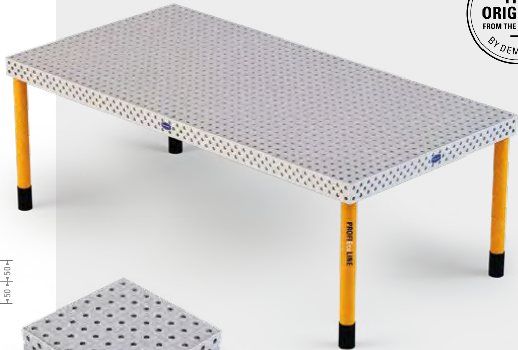
3 rijen boorbeeld aan de tafelijanten met systeemboring D16 in een raster van 50 mm in de bovenste, middelste en onderste rij
